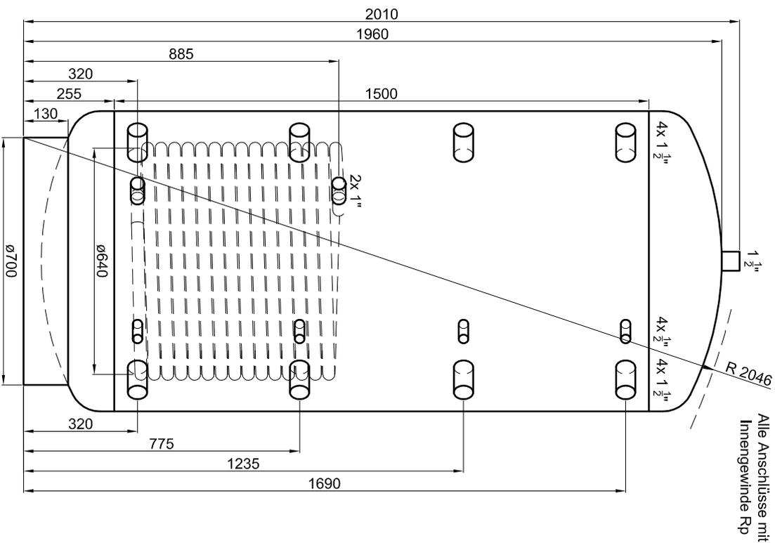
Alle Anschlüsse mit Innengewinde Rp
